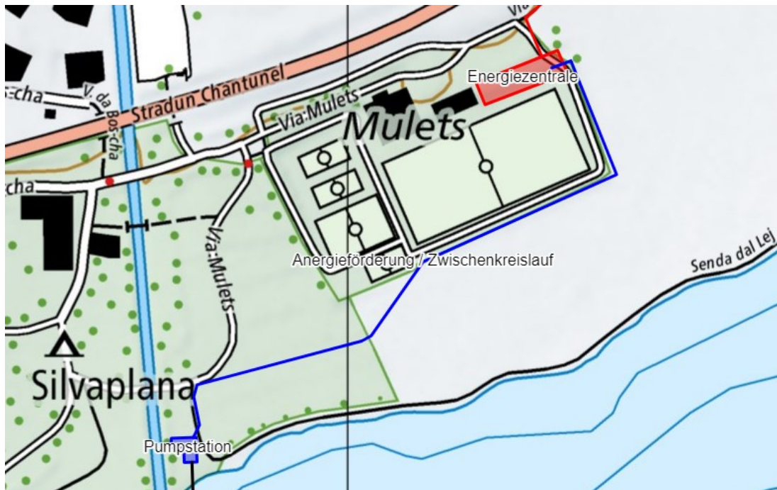
Abbildung 5: Die Abbildung zeigt einen Ausschnitt aus dem map.geo.admin.ch, welcher für diverse Notizen und Vermessungen verwendet wurde. Die blaue Linie von der Pumpstation bis hoch zur Energiezentrale zeigt die Führung der Anergieleitung auf.
